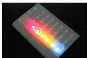
■最後の実験Ⅲ「LED光の三原色混色キットを組み立てよう！」では、光の三原色混色キットの最終部分を組み立てました。完成したキットを使って赤・青・緑の出力の強さをドライバで調節して様々な色を作り、配布資料に記録しました。
